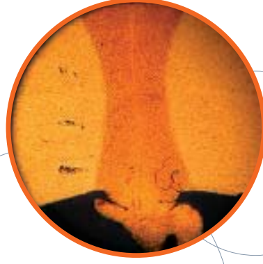
İç çapaklı normalize olmamış boru
